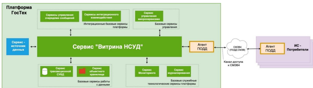
Рисунок 2 - Схема построения витрины данных НСУД на платформе «ГосТех».
