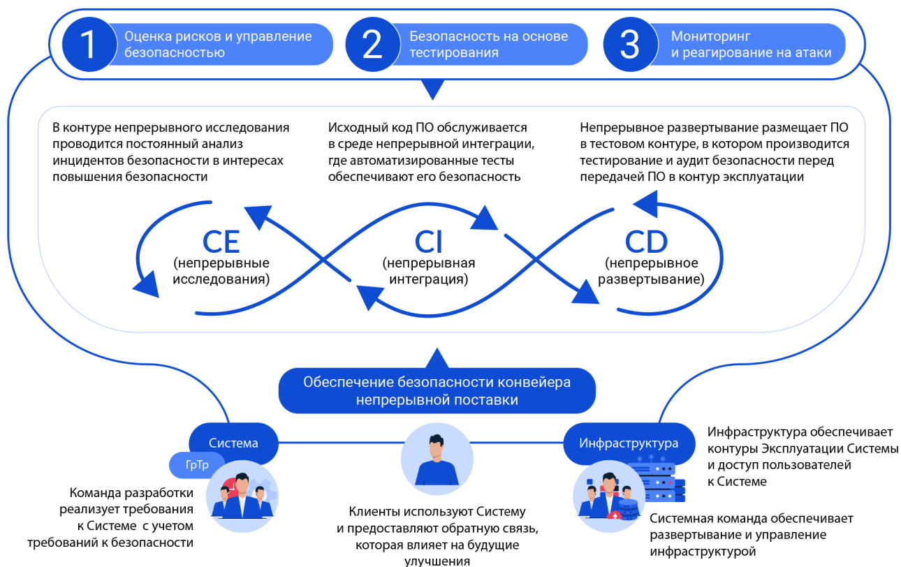
Рисунок 32. Три фазы обеспечения непрерывной безопасности
